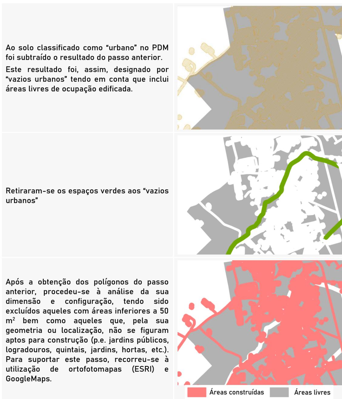
Figura 69. Descrição da metodologia para determinar as áreas efetivamente construídas
